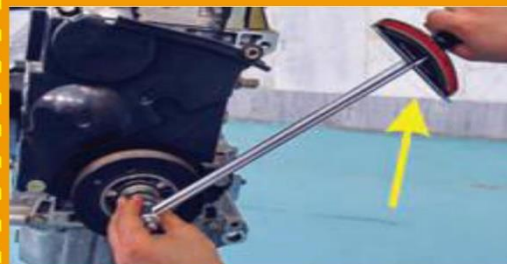
نحوه کاربرد آچار درجه دار عقربه ای
