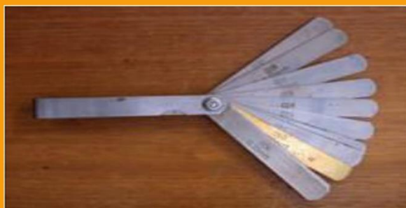
یک نوع فیلر میلیمتری با تیغه های میلیمتری و معادل اینچی آن.
