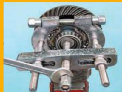
یک نوع بلبرینگ کش و کاربرد آن برای خارج کردن بلبرینگ
