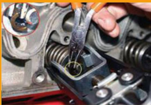
خارج کردن خار آزاد شده فنر سوپاپ
