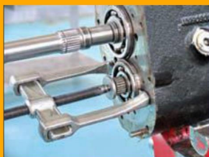
کاربرد پولی کش برای خارج کردن بلبرینگ روی محور جعبه دنده
