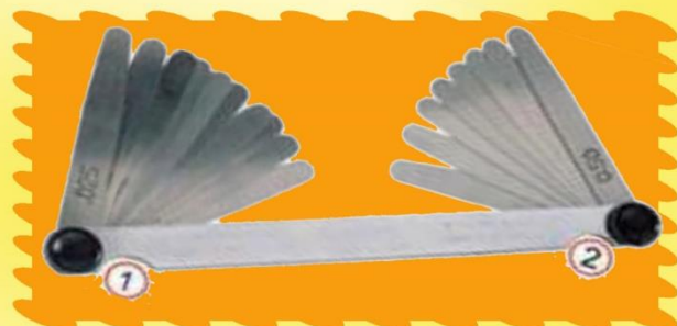
فیلر میلیمتری اینچی، ۱. فیلر اینچی، ۲. فیلر میلیمتری
